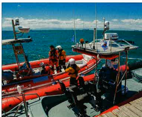
Les services de sécurité de nombreux pays utilisent de grands semi-rigides équipés de sièges suspendus.
